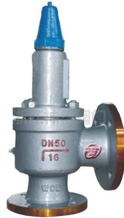
③对于具有上、下调节圈（导向套和阀座上各有一个调节圈）的结构，其调整要复杂一些。阀座调节圈用来改变阀瓣与调节圈之间通道的大小，从而改变阀门初始开启时压力在阀瓣与调节圈之间腔室内积聚程度的大小。当升高阀座调节圈时，压力积聚的程度增大，从而使阀门比例开启的阶段减小而较快地达到突然的急速开启。因此，升高阀座调节圈能使排放压力有所降低。应当注意的是，阀座调节圈亦不可升高到过分接近阀瓣。那样，密封面处的泄漏就可能使阀门过早地突然开启，但由于此时介质压力还不足以将阀瓣保持在开启位置，阀瓣随即又关闭，于是阀门发生频跳。阀座调节圈主要用来缩小阀门比例，开启的阶段和调节排放压力，同时也对回座压力有所影响。
