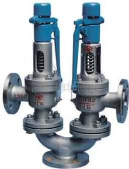
定义：**安全阀**是一种安全保护用阀，它的启闭件受外力作用下处于常闭状态，当设备或管道内的介质压力升高，超过规定值时自动开启，通过向系统外排放介质来防止管道或设备内介质压力超过规定数值。安全阀属于自动阀类，主要用于锅炉、压力容器和管道上，控制压力不超过规定值，对人身安全和设备运行起重要保护作用。
